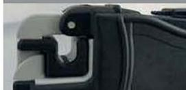
小直径电缆的对中适配器，可提高对中精度和测量精度。
