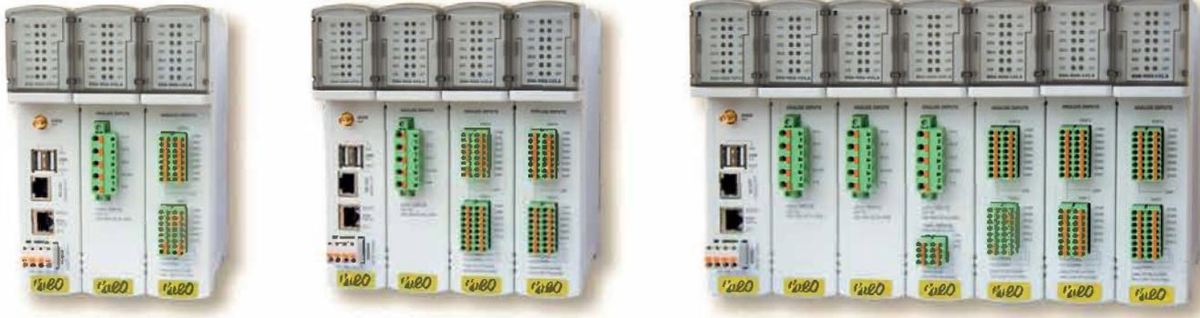
PQM-100基于模块化体系结构，可将一个CPU模块和多达6个选定的输入模块组合成一台仪表。输入模块提供输入信号隔离，滤波和A/D转换。CPU模块配备有计算各种参数的FPGA实时控制器，并提供多种接口和数据存储。
